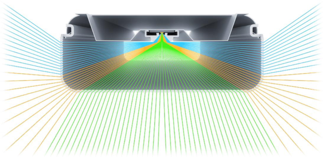
Durch ein hochmodernes optisches Design wird das Licht nach unten, zur Seite und nach oben gelenkt
